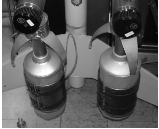
(b) HP West's VacSorb cryopumps.
